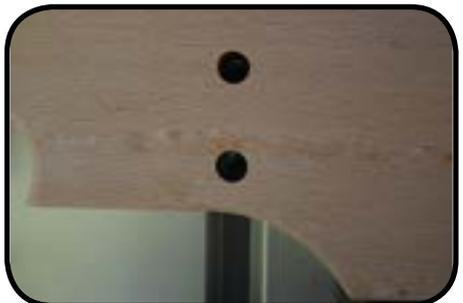
2. Nutensteine so positionieren, dass sie mit den Bohrungen in einer Flucht liegen.
