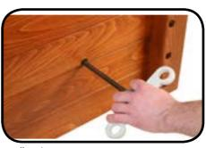
7. In die vorgebohrten Löcher bitte die Fahrwerkfeststeller einsetzen.
